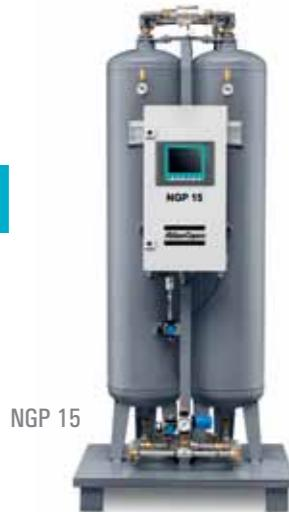
В новых установках для получения азота от компании «Атлас Копко» используется технология короткоцикловой адсорбции (PSA) для отделения молекул азота от других молекул, содержащихся в сжатом воздухе. Адсорбируется кислород, CO<sub>2</sub>, пары воды и другие газы. В результате, на выходе установки получается азот высокой степени чистоты от 95 до 99,999%.
