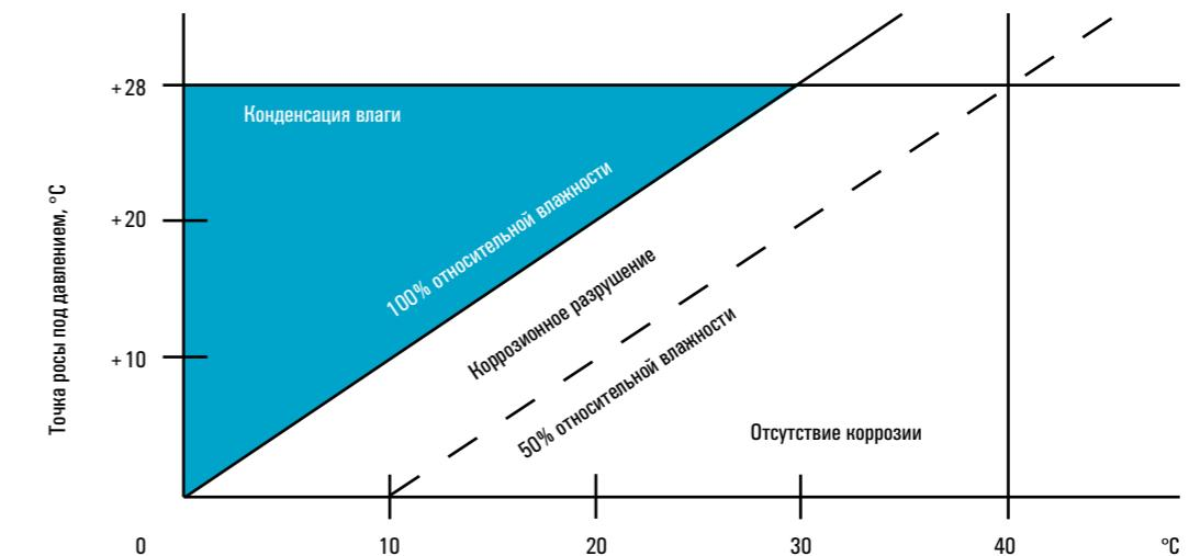
Область под пунктирной линией соответствует воздуху с влажностью, не превышающей 50%. Например, если температура окружающей среды 25°C, то для предотвращения коррозии достаточно, чтобы точка росы была не выше 13°C.
